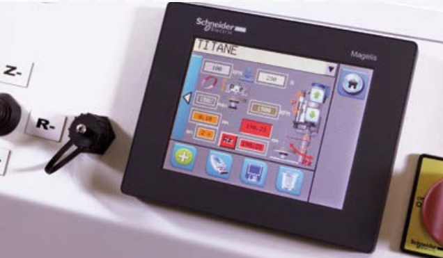
Écran de contrôle tactile 5,7" avec interface graphique imagée.
