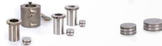
Corps de chauffe pour moules d'enrobage de Ø 25,4 (1"), 30, 40, 1 1/4, 1 1/2, 50 et 2". Pistons pour double enrobage
