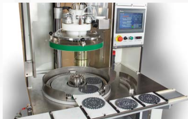
09 2380DE 20 Système de déchargement des satellites avec rampe de préparation
