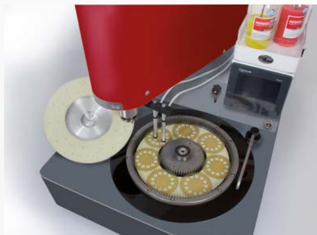
Montée et descente du plateau supérieur par vérin pneumatique.
