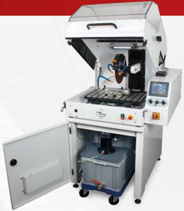
Meuble support avec système de recirculation (60 litres).
