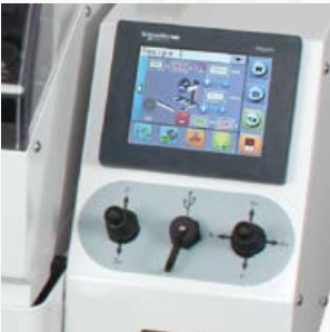
Positionnement rapide avec joysticks. Écran tactile avec interface graphique.
