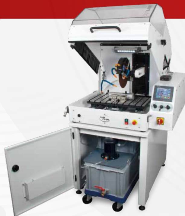
Meuble support avec système de recirculation (60 litres).
