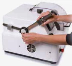
Réglage manuel micrométrique de l'axe Z.
