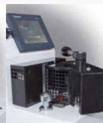
Position de sécurité récupération échantillon
