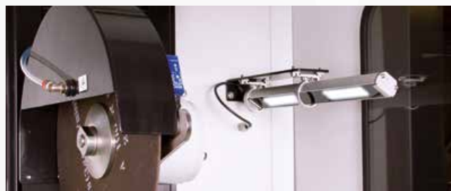
Puissant éclairage de la zone de coupe par LED
