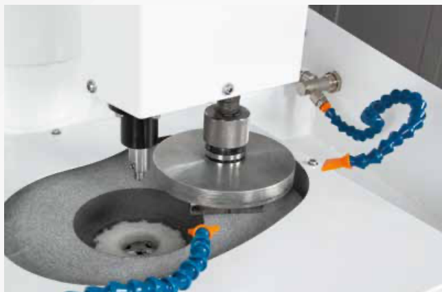
Prépolissage d'échantillons brutes de grande taille.
