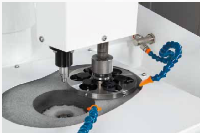
Prépolissage d'échantillons enrobés, montés sur porte-échantillon à pression centrale.
